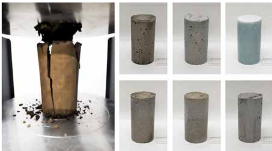
Kuva 2 Puristettu lieriö ja koekappaleita. Kuvat Soili Solismaa ja Pasi Heikkilä
