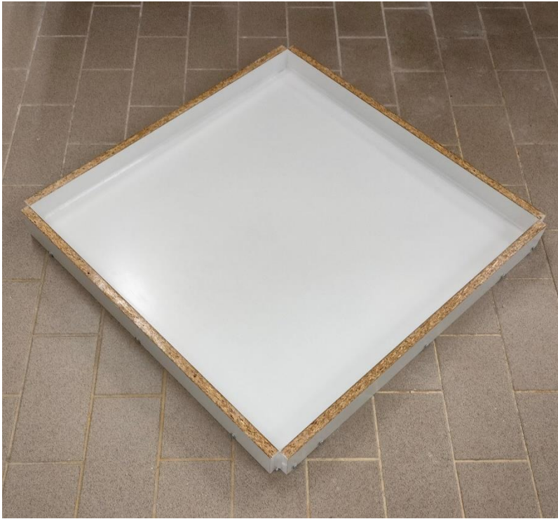
Pöytälevyjen valmistukseen käytetty muotti
