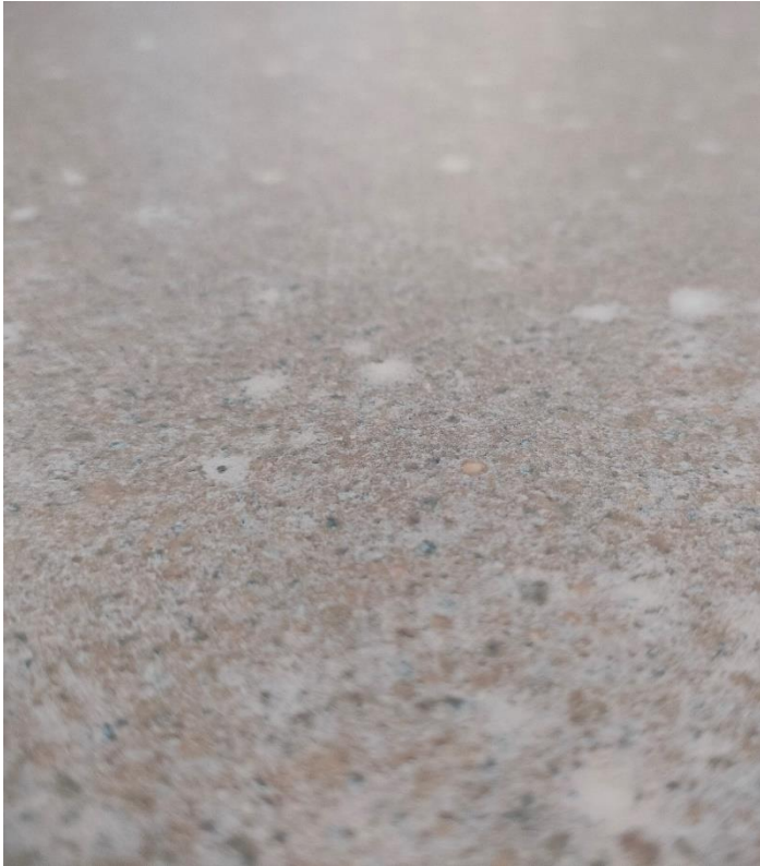
Toisen pöytälevyn pinnassa ei ollut juurikaan jälkiä kuplista
