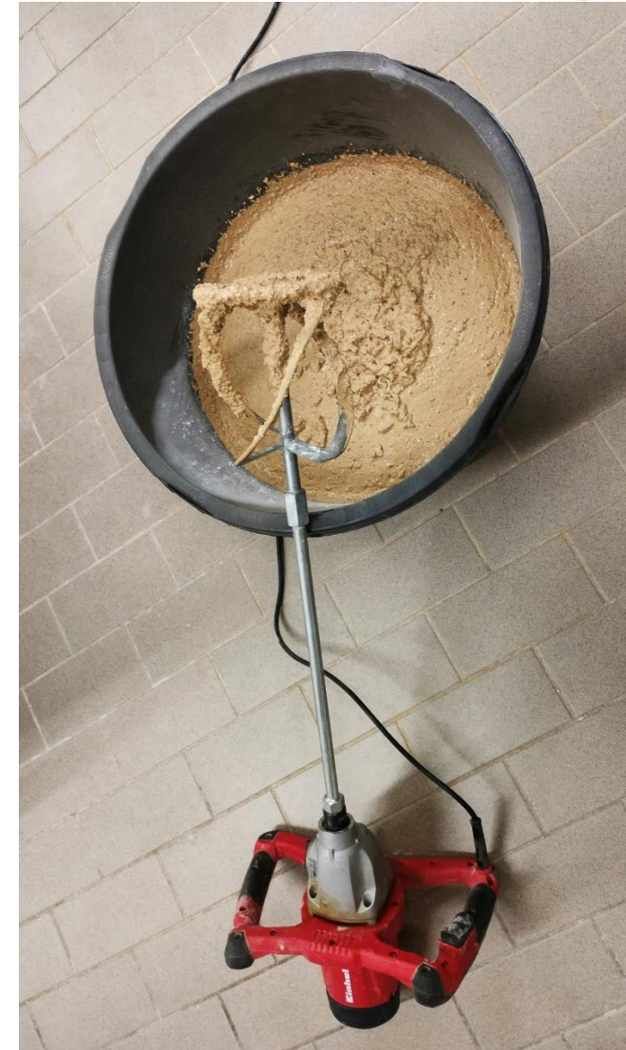
Pöytälevyjen laastin sekoitukseen käytetyt välineet
